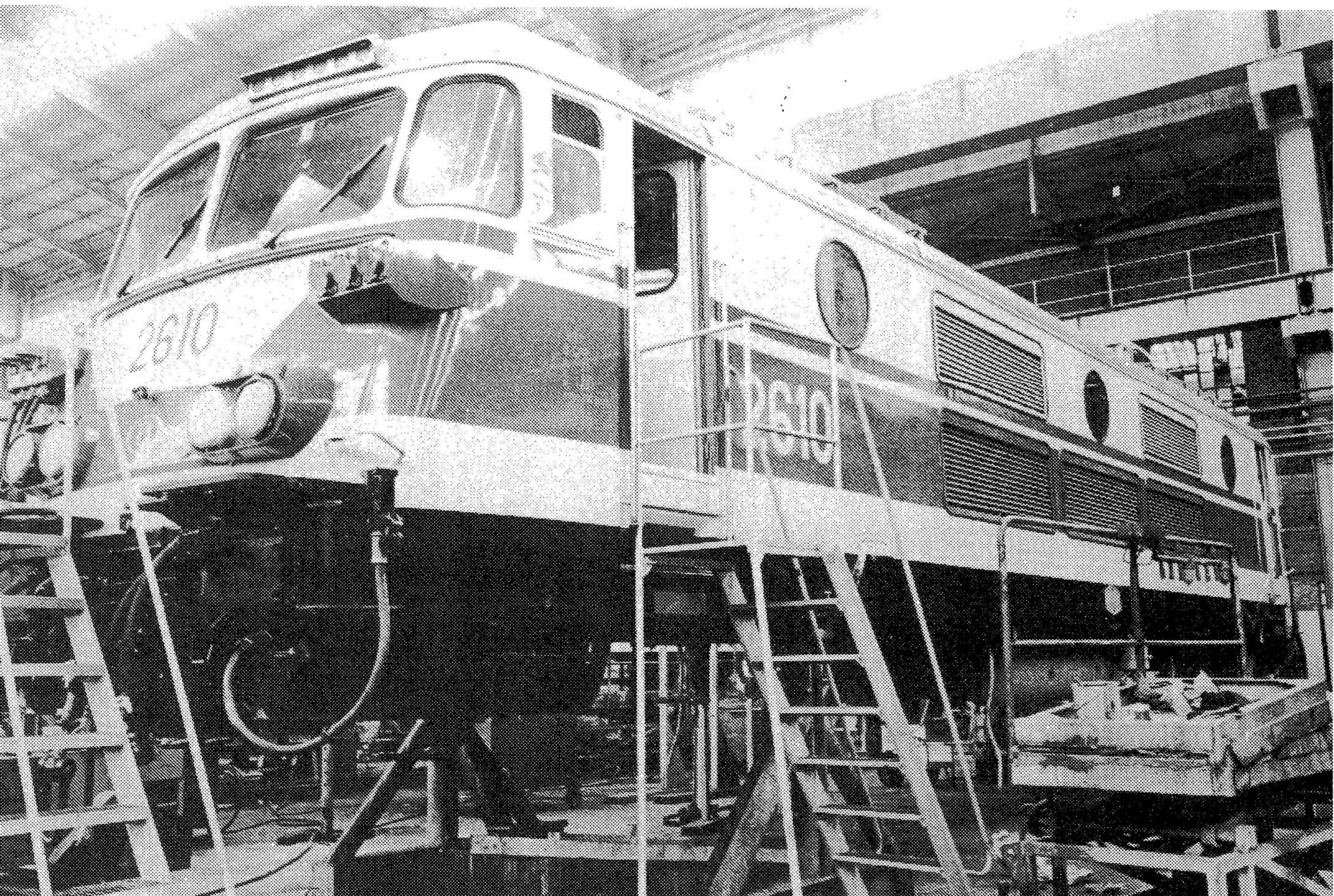
▼ Hall 08. Locomotive électrique type 26 en chaîne de réparation.
